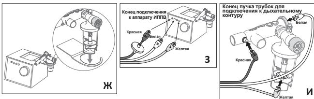
Каждая отдельная трубка имеет цветовую маркировку и быстроразъемный соединитель с обеих сторон. К вентилятору ИППВ присоединяют тот конец трубок, где на красной трубке находится фильтр (**рис. 3**).
